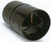
스파이럴덕트 F.D • 재질 : STEEL 1.6T / 분체도장 • 규격 : \phi 100, \phi 125, \phi 150, \phi 200
